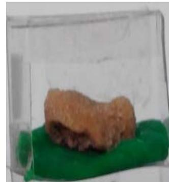
Gambar 2. Sampel batu ginjal yang diletakkan pada holder dan dilapisi plastisin agar tidak bergerak
