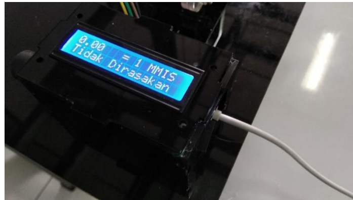
Gambar 7. Hasil pembacaan getaran pada LCD
