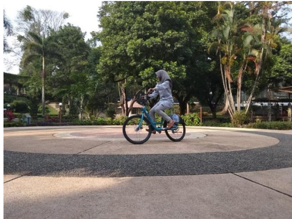
Gambar 4. Pengambilan data percepatan sentripetal dan sudut antara sepeda dan garis vertical dengan menggunakan aplikasi Phypox pada smartphone pada lintasan melingkar.
