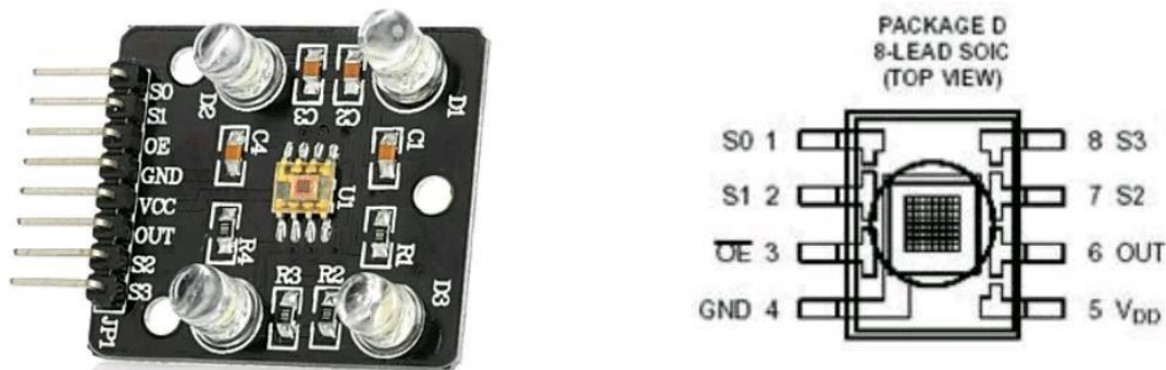
Gambar 3. (a) bentuk fisik sensor TCS230 (b) skema pin sensor TCS230 (mohon tambahkan referensi jika gambar ini diambil dari karya ilmiah lain)
