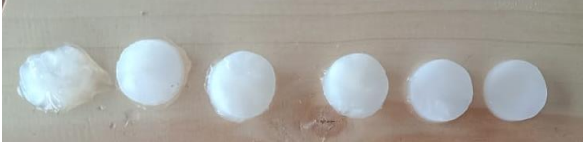
Gambar 1. Hasil hidrogel yang dibuat dengan jumlah cycle satu hingga enam dengan durasi freeze-thaw 17/7 jam
