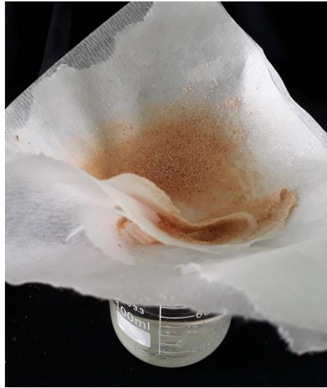
Gambar 4. Proses penyaringan hasil ekstrak unsur calcium dari cangkang telur setelah cangkang telur direndam selama 30 menit di dalam pelarut asam acetate.
