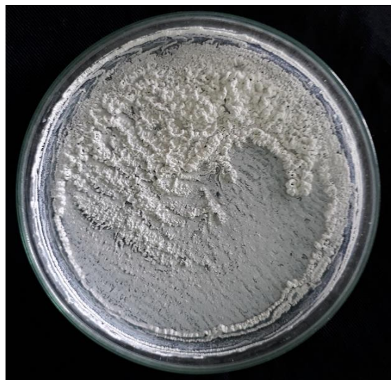
Gambar 5. Kristal calcium acetate monohydrate \text{Ca}(\text{CH}_3\text{COO})_2 \cdot \text{H}_2\text{O} yang diperoleh dari hasil pemanasan cairan hasil ekstrak calcium dari cangkang telur menggunakan pelarut asam acetate.
