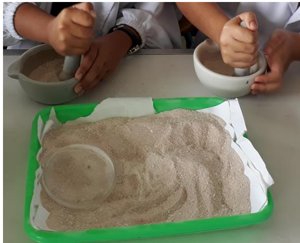
Gambar 2. Proses penggilingan cangkang telur yang telah bersih dan kering dengan menggunakan mortar.
