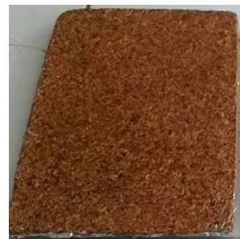
Gambar 4. Papan komposit ampas sagu
