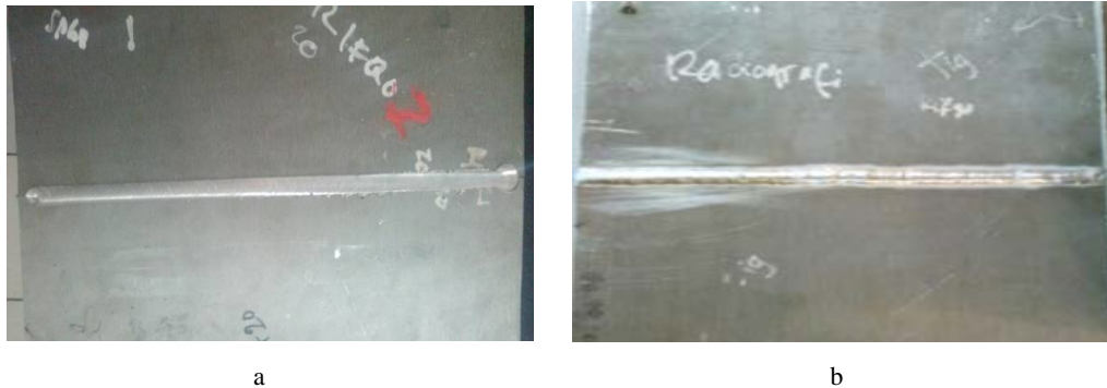
Gambar 3. Hasil Pengelasan : a) FSW, b) GTAW
