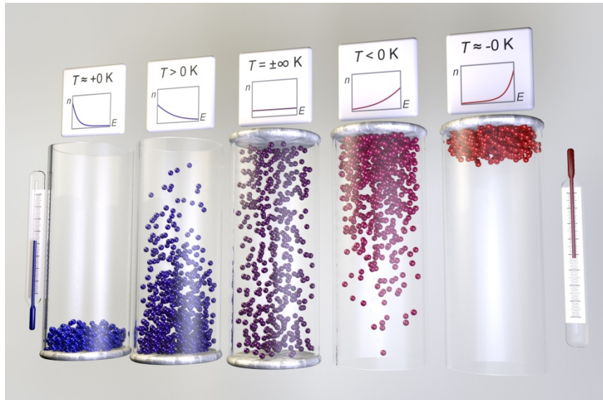
Gambar 3. Ilustrasi distribusi Boltzmann pada berbagai temperatur. (a) Pada temperatur +0 K, (b) pada temperatur positif, (c) pada temperatur \pm \infty K, d) pada temperatur negatif, dan (e) pada temperatur -0 K [6].
