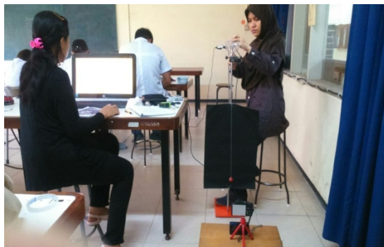
Gambar 2. Rangkaian alat praktikum bandul matematis yang terdiri atas statif, set bandul, sensor dan PC, serta dua buah kamera video.
