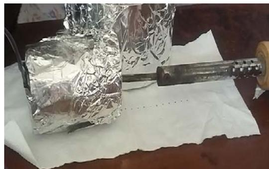
Gambar 4. Pengujian pengukuran suhu ujung panas solder menggunakan sensor MLX90614 di dalam *shielding*.
