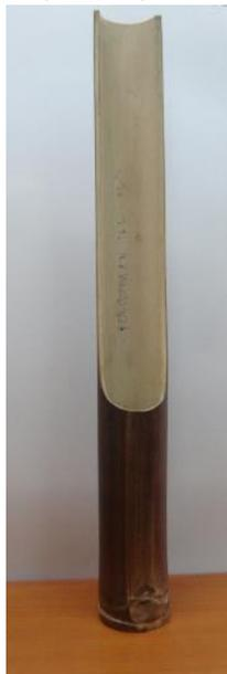
Gambar 3. Tabung Suara untuk Pengujian
