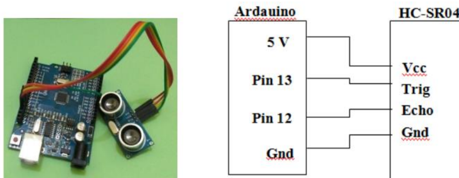
Gambar 1. Rangkaian sambungan antara arduino uno dengan sensor ultrasonik HC-SR04
