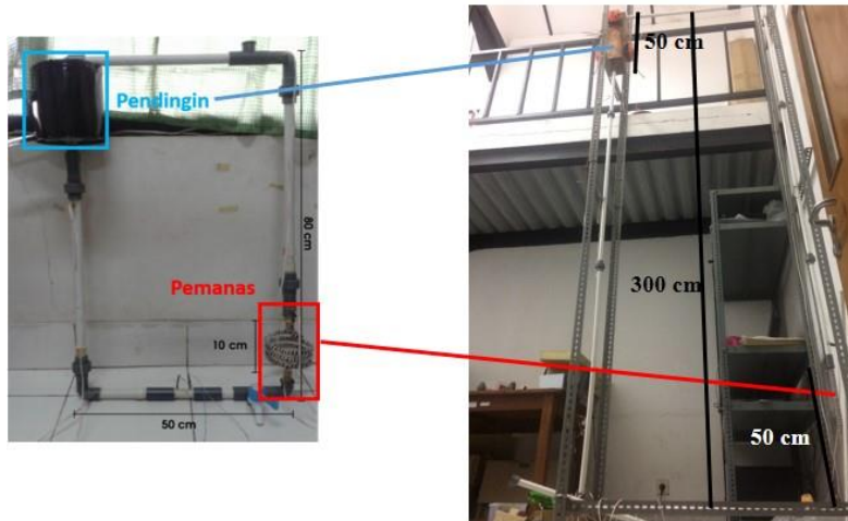
Gambar 1. Aparatus Sistem Sirkulasi Alami awal eksperimen dengan bagian pendingin dan pemanas yang telah diperbaiki menyerupai bentuk pada simulasi
