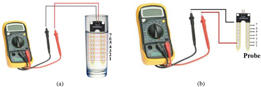
Gambar 14. (a). Rangkaian untuk mengetahui pengaruh kedalaman probe tiap segmen pada medium (air) terhadap nilai resistivitas (b). Rangkaian untuk mendapatkan nilai resistansi Probe tiap segmen.
