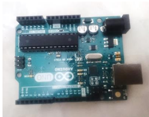
Gambar 5. Arduino Uno R3
