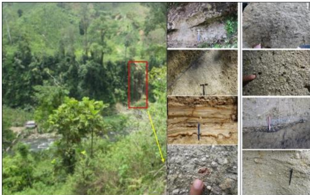
Gambar 2. Singkapan Ignimbrite di daerah Sungai Nilo yang memiliki beberapa rangkaian endapan piroklastik
