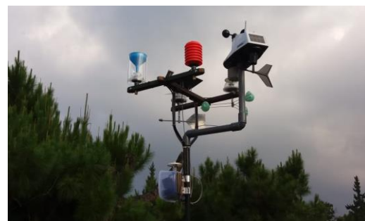
Gambar 8. AWS Davis Model Vantage Vue (kiri) dan AWS yang sudah dibuat disandingkan dengan AWS Vantage Vue (kanan)
