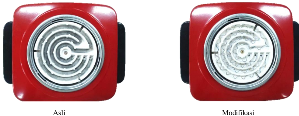
Gambar 9. Perbandingan Elemen Pemanas Kompor Listrik Asli dan Modifikasi
